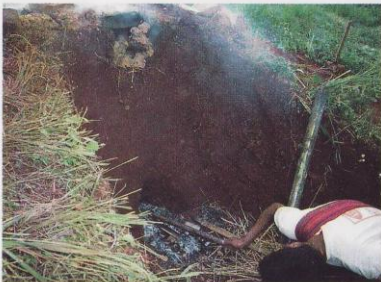
မီးရှို့ပေါက်မှနေ၍ မီးရှို့ပါ။ မီးကောင်စွာစွဲရန်အတွက် ဇေကာဖြင့်လေဟာပေးရန် လိုအပ်ပါသည်။
